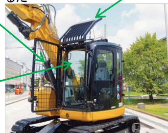
運転室周りの飛来物防護設備の例
